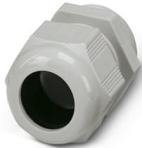
Presse-étoupe, matériau du raccordement vissé: PA, diamètre extérieur du câble 18 mm ... 25 mm, blindage: non, filetage de raccordement: M32 x 1,5, coloris: gris clair RAL 7035
