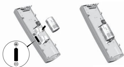
**FR** Le produit émet un bip à chaque détection, la pile est usée. Avant d'ouvrir le boîtier, la centrale doit être en mode Maintenance (voir notice d'installation système).
