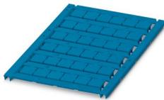
Repères pour blocs de jonction, Planche, bleu, vierge, repérable avec : TOPMARK NEO, LASER TOPMARK, BLUEMARK ID COLOR, BLUEMARK ID, BLUEMARK CLED, THERMOMARK PRIME, THERMOMARK CARD 2.0, THERMOMARK CARD, type de montage: encliquetage, pour bloc de jonction au pas de : 10,2 mm, surface utile: 8,9 x 9,6 mm, Nombre d'étiquettes: 36
