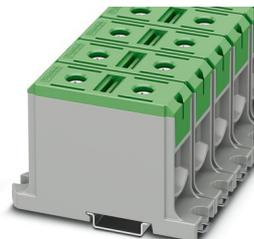
Bloc de jonction de puissance, tension nominale: 1000 V, intensité nominale: 290 A, nombre de connexions: 2, nombre de pôles: 1, type de raccordement: Raccordement vissé, Section de référence: 150 mm<sup>2</sup>, section : 35 mm<sup>2</sup> - 150 mm<sup>2</sup>, Section de référence: 150 mm<sup>2</sup>, section : 35 mm<sup>2</sup> - 150 mm<sup>2</sup>, type de montage: NS 35/15, NS 35/7,5, coloris: vert
