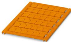
Repères pour blocs de jonction, Planche, orange, vierge, repérable avec : TOPMARK NEO, LASER TOPMARK, BLUEMARK ID COLOR, BLUEMARK ID, BLUEMARK CLED, THERMOMARK PRIME, THERMOMARK CARD 2.0, THERMOMARK CARD, type de montage: encliquetage, pour bloc de jonction au pas de : 10,2 mm, surface utile: 8,9 x 9,6 mm, Nombre d'étiquettes: 36
