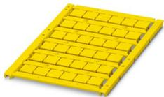
Repères pour blocs de jonction, Planche, jaune, vierge, repérable avec : TOPMARK NEO, LASER TOPMARK, BLUEMARK ID COLOR, BLUEMARK ID, BLUEMARK CLED, THERMOMARK PRIME, THERMOMARK CARD 2.0, THERMOMARK CARD, type de montage: encliquetage, pour bloc de jonction au pas de : 10,2 mm, surface utile: 8,9 x 9,6 mm, Nombre d'étiquettes: 36
