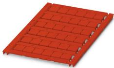
Repères pour blocs de jonction, Planche, rouge, vierge, repérable avec : TOPMARK NEO, LASER TOPMARK, BLUEMARK ID COLOR, BLUEMARK ID, BLUEMARK CLED, THERMOMARK PRIME, THERMOMARK CARD 2.0, THERMOMARK CARD, type de montage: encliquetage, pour bloc de jonction au pas de : 10,2 mm, surface utile: 8,9 x 9,6 mm, Nombre d'étiquettes: 36
