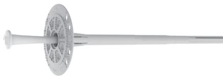
Cheville à frapper avec clou d'expansion plastique pour fixation de polystyrène expansé (EPS) et panneaux de laine minérale pour isolation thermique extérieure par enduit (ETICS)
