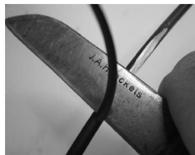
Retirer environ 10cm de gaine extérieur sans abimer l'intérieur du câble. Si vous endommagé le tube ou la fibre, couper la partie endommagée et recommencé.
