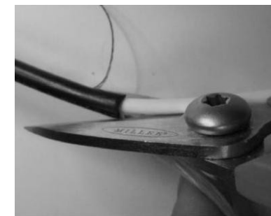
Coupez la gaine extérieur et les fils d'aramide.
