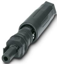
Connecteur, Famille d'articles: Sunclix, matériau du boîtier: PPE, coloris: noir, nombre de pôles: 1, section de fil min.: 2,5 mm<sup>2</sup>, section de fil max.: 6 mm<sup>2</sup>, tension de référence: 1500 V DC, courant de référence: 35 A, Type de raccordement: A ressort, Type de contact: Connecteur femelle, diamètre de câble min.: 5 mm, diamètre de câble max.: 8 mm
