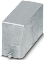
Capot passe-câble B24, pour étrier longitudinal, matériau: Aluminium coulé sous pression, résistant à l'eau de mer, variable, hauteur: 60 mm, presse-étoupe: sans, Standard, sans trou fileté pour raccordement vissé
