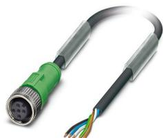
Câble pour capteurs/actionneurs, 5-pôles, PUR exempt d'halogène, gris-noir RAL 7021, extrémité libre, sur Connecteur femelle droit M12, détrompage: A, longueur de câble: 0,6 m
