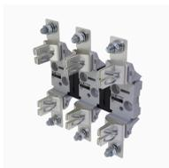
**Socle pour fusible, Basse tension, 630 A, AC 690 V, NH3, 3P, IEC, montage sur barre DIN**
