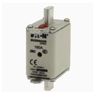
**Cartouche fusible, Basse tension, 160 A, AC 660 V, 50 kA, NH00, gL/gG, IEC, à double indicateur de fusion, pattes d'extraction conductrices**
