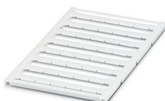
Repères pour blocs de jonction, à commander : sous forme de planche, blanc, impression selon les indications du client, type de montage: encliquetage dans la rainure de repérage plate, pour bloc de jonction au pas de : 12 mm, surface utile: 11,45 x 5,1 mm, Nombre d'étiquettes: 40
