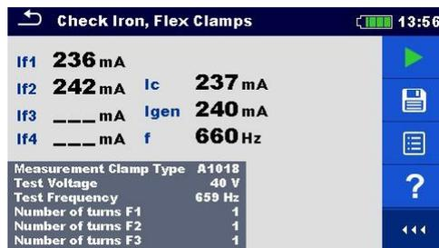
Image 11.104: Exemple de mesure de vérification des pinces classiques et des pinces flex
