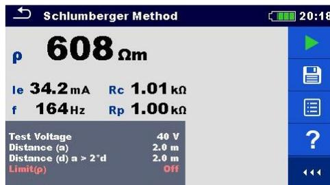
Image 11.48: Exemple de résultats de mesure avec la méthode Schlumberger
