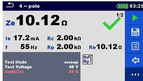
Image 10.2: Ecran de résultat d'un exemple de test simple de mesure à 4 pôles
