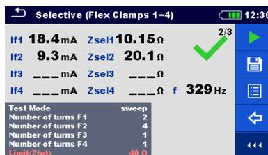
Image 11.34: Exemple de résultats de mesure sélective (Pincas Flex 1-4) - Zsel1-4
