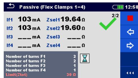
Image 11.40: Exemple de résultats de mesure passive (Pincas Flex)
