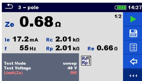
Image 11.14: Exemple de résultat de mesure à 3 pôles
