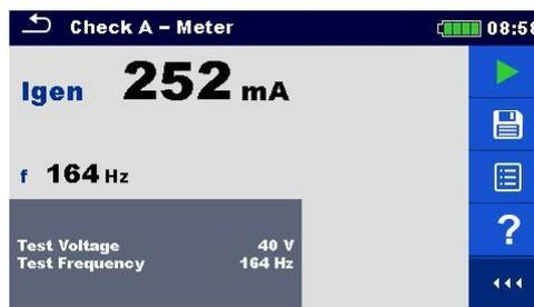
Image 11.102: Exemple de mesure de vérification en courant
