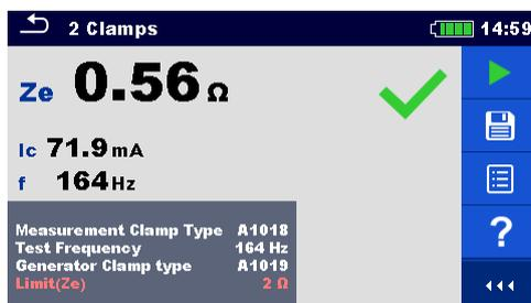
Image 11.26: Exemple de résultat de mesure à deux pincés
