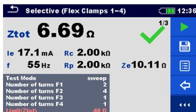
Image 11.33: Exemple de résultats de mesure sélective (Pincas Flex 1-4) - Ztot
