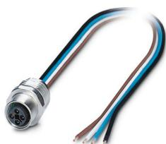
Embases paroi avant, Puissance, 4-pôles, connecteur femelle, droit, M12, détrompage: T, sur extrémité libre, Montage sur face avant, Bride carrée, Cordons individuels, longueur de câble: 3 m, 1,31 mm<sup>2</sup>, Tresse de connexion UL/cUL, Produit de remplacement selon RoHS II sans exception 6c (Pb < 0,1 %) référence : 1239508
