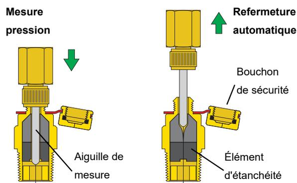
Les vannes sont équipées de prises de pression de type raccord rapide. Avec ce type de prise, à l'aide des aiguilles Caleffi de série 100, l'opération de mesure s'effectue rapidement et précisément. Quand on retire l'aiguille de mesure, la prise se referme automatiquement en évitant une éventuelle perte d'eau.
