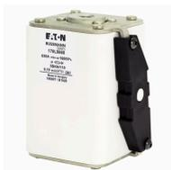
**Cartouche fusible, grande vitesse, 630 A, AC 1600 V, size 3, 85 x 96 x 112 mm, aR, IEC, indicateur de type K**
