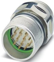
M23, Embases paroi avant, série: CA, droit, blindé: oui, Pour verrouillage standard et SPEEDCON, Nombre de pôles: 16+3, Sens de rotation: standard, type de contact: Mâle, Raccordement soudé, Joint axial, Fixation centrale M20 x 1,5, à positionner via un écrou de sécurité, détrompage: N
