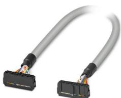
Câble rond pré-équipé; raccordement 1 : IDC/FLK connecteur femelle (1x 20-pôles); raccordement 2 : IDC/FLK connecteur femelle (1x 20-pôles); longueur de câble: 3 m
