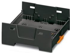
Boîtier électronique sur rail DIN, Partie inférieure du boîtier avec base encliquetable, design plat, largeur: 70,1 mm, hauteur: 75 mm, profondeur: 30,3 mm, coloris: noir (9005)
