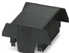
Boîtier électronique sur rail DIN, Partie supérieure du boîtier, design plat, ouverture de raccordement des deux côtés, largeur: 70,1 mm, hauteur: 74,65 mm, profondeur: 36,95 mm, coloris: noir (9005)
