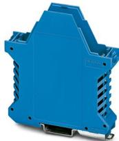
Boîtier électronique sur rail DIN, Partie inférieure du boîtier avec pied métallique de verrouillage, design élancé, avec fentes d'aération, largeur: 22,6 mm, hauteur: 99 mm, profondeur: 107,3 mm, coloris: bleu (5015), connexion transversale: sans connecteur de bus, nombre de pôles connecteur transversal: sans objet
