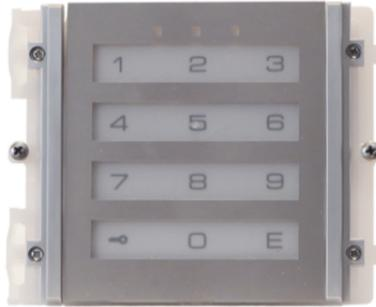
Module clavier à codes avec rétroéclairage à leds sélectionnable entre bleu, blanc et off, finition acier inox. En saisissant sur le clavier un code de 1 à 8 chiffres, deux relais (10 A) permettent d'actionner un système de fermeture électrique ou tout autre dispositif d'ouverture de porte. Dimensions 112x89,5x40 mm.
