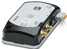
Point d'accès WLAN, client, Mesh pour USA et Canada, avec deux prises d'antenne extérieures (RSMA-F), IP20, WLAN 802.11a, b, g, n, fréquence : 2,4 GHz, 5 GHz, raccords : MINICONNEC 9 V DC ... 32 V DC, RJ45 : pour LAN, web, http/https, CLI, REST-API
