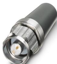
Antenne omnidirectionnelle multibande pour applications mobiles, design compact, bande de fréquence : 2,4 GHz/5 GHz/6 GHz, gain : 2,0 dBi/2,5 dBi/3,0 dBi, indice de protection : IP68/IP69K, résistant aux chocs et aux vibrations, raccordement : N (mâle)
