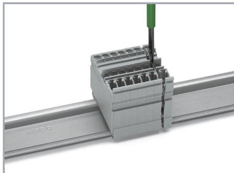
Ouvrir l'ensemble à l'aide d'un outil de manipulation (lame 3,5 x 0,5 mm).
