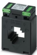
Transformateur de courant enfichable, courant primaire 300 A AC, courant secondaire 5 A AC ; classe de précision 1 ; puissance assignée 7,5 VA
