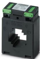
Transformateur de courant enfichable, courant primaire 150 A AC, courant secondaire 5 A AC ; classe de précision 1 ; puissance assignée 3,75 VA
