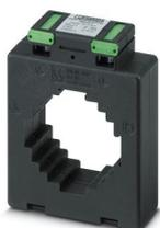
Transformateur de courant enfichable, courant primaire 400 A AC, courant secondaire 5 A AC ; classe de précision 1 ; puissance assignée 2,5 VA
