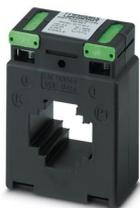
Transformateur de courant enfichable, courant primaire 125 A AC, courant secondaire 5 A AC ; classe de précision 1 ; puissance assignée 3,75 VA
