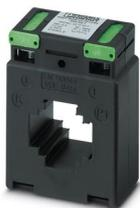
Transformateur de courant enfichable, courant primaire 200 A AC, courant secondaire 5 A AC ; classe de précision 1 ; puissance assignée 7,5 VA
