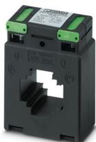
Transformateur de courant enfichable, courant primaire 60 A AC, courant secondaire 5 A AC ; classe de précision 1 ; puissance assignée 1,25 VA
