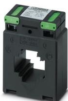
Transformateur de courant enfichable, courant primaire 100 A AC, courant secondaire 5 A AC ; classe de précision 1 ; puissance assignée 2,5 VA
