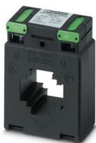
Transformateur de courant enfichable, courant primaire 150 A AC, courant secondaire 5 A AC ; classe de précision 1 ; puissance assignée 5 VA
