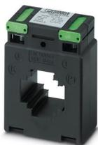
Transformateur de courant enfichable, courant primaire 250 A AC, courant secondaire 5 A AC ; classe de précision 1 ; puissance assignée 7,5 VA
