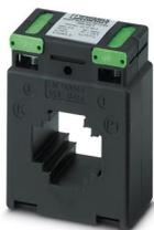
Transformateur de courant enfichable, courant primaire 400 A AC, courant secondaire 5 A AC ; classe de précision 1 ; puissance assignée 10 VA
