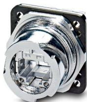
Cadre de montage RJ45, IP67, pour verrouillage à baïonnette, métal, avec élément de contact pour raccordement de câble, pour découpe de montage ronde, avec joint, sans vis de fixation
