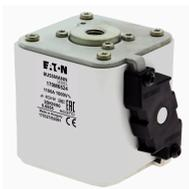
**Cartouche fusible, grande vitesse, 800 A, AC 2000 V, size 3, 99 x 171 x 142 mm, aR, IEC, indicateur de fusion simple**
