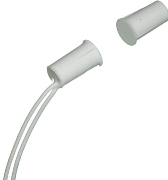
Détecteur à contact magnétique à encastrer forme tube en matière plastique, court, ne convient pas au montage sur fenêtres en métal. Coloris Blanc. Dimensions : 18x11x11mm.
