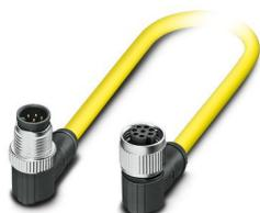
Câble pour capteurs/actionneurs, 8-pôles, PVC, jaune, connecteur mâle coudé M12, détrompage: A, sur Connecteur femelle coudé M12, détrompage: A, longueur de câble: 0,5 m
