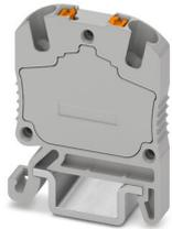
Micro-bloc de jonction de traversée, tension nominale: 500 V, intensité nominale: 17,5 A, nombre de connexions: 2, type de raccordement: Raccordement Push-in, section : 0,14 mm<sup>2</sup> - 1,5 mm<sup>2</sup>, type de montage: NS 15, coloris: gris
