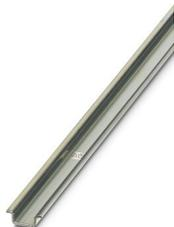
Profilé plein, selon EN 60715, matériau: Acier, galvanisé, traité par passivation couche épaisse, Profil standard, coloris: argenté, Conditionnement par 10 unités (20 m)
