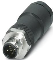
Connecteur, 5-pôles, connecteur mâle droit M12, détrompage: A, Raccordement vissé, matériau de la molette: Acier inoxydable 1.4404, presse-étoupe Pg11-DUO, diamètre extérieur du câble 2,1 mm ... 3 mm / 4 mm ... 5,2 mm
