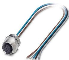
Embases paroi avant, 5-pôles, connecteur femelle, droit, M12, détrompage: A, sur extrémité libre, Montage sur face avant, Cordons individuels, longueur de câble: 2,5 m, 0,34 mm<sup>2</sup>, Cordon TPE
