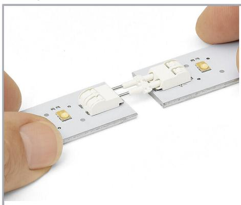
Connexion/déconnexion des circuits imprimés
