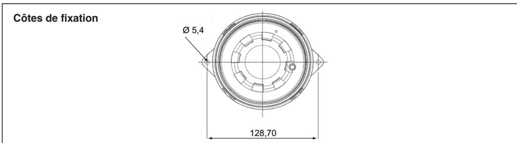
Le socle anti-ruissellement isole de l'écoulement d'eau et de la poussière la base des détecteurs automatiques.
