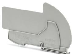
Séparateur VIP I/O-Marshalling pour la séparation sûre entre des modules embase équipés non Ex i et Ex i, dans des systèmes Honeywell. Le séparateur est montée directement sur le rail DIN, à l'extrémité du module embase.
