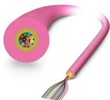
Câble universel GOF, à 12 fils, câble mini breakout pour pose fixe, protection anti-rongeurs non métallique, retrait facile, résistant aux UV, capacité de charge mécanique et thermique élevée, fumivore, sans halogène et auto-extincteur, stabilité améliorée, résistance à l'eau longitud. et transv.
