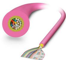
Câble universel GOF, à 24 fils, câble mini breakout pour pose fixe, protection anti-rongeurs non métallique, retrait facile, résistant aux UV, capacité de charge mécanique et thermique élevée, fumivore, sans halogène et auto-extincteur, stabilité améliorée, résistance à l'eau longitud. et transv.
