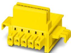
Connecteur de bus sur rail DIN, intensité nominale : 8 A (contacts parallèles), tension de référence (III/2) : 125 V, nombre de pôles : 5, pas : 3,81 mm, couleur : jaune, montage : rail DIN, produit avec contacts dorés, connecteur de bus pour le raccordement de boîtiers électroniques, 5 contacts parallèles
