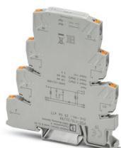
Bloc de jonction pour le filtrage d'impulsions d'essai de sorties à semi-conducteurs sécurisées avec valeurs de filtrage réglables (20  $\mu$ F/86  $\mu$ F), et pour le filtrage CEM de signaux 24 V jusqu'à une intensité de courant de 2 A.
