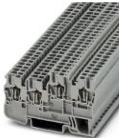
Bloc de jonction pour capteurs / actionneurs, Mode de raccordement: Raccordement à ressort, Section :0,08 mm<sup>2</sup> - 4 mm<sup>2</sup>, AWG: 28 - 12, Largeur: 5,2 mm, Coloris: gris, Type de montage: NS 35/7,5, NS 35/15
