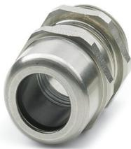
Presse-étoupe, matériau du raccordement vissé: Acier inoxydable 1.4305, diamètre extérieur du câble 11 mm ... 17 mm, blindage: non, filetage de raccordement: M25 x 1,5, coloris: argenté, avec joint torique
