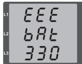
*Fig. Erreur d'horloge/ de pile avec numéro 330 (L'horloge est affichée et doit être réglée).*
