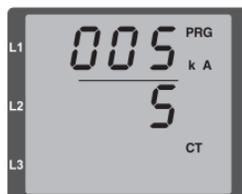
*Fig. Mode de programmation du transformateur de courant*
