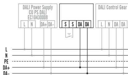
Raccordement avec commande optionnelle par poussoir.
