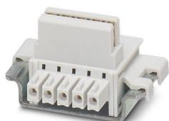
Connecteurs sur profilé, coloris: gris clair, intensité nominale: 8 A, 8 A (contacts parallèles) (Contacts série), tension de référence (III/2): 50 V, nombre de pôles: 5, pas: 3,81 mm, montage: Montage sur profilé, verrouillage: sans, type de fixation: sans, type de conditionnement: emballé dans un carton, Article avec contacts dorés, connecteur de bus pour le raccordement de boîtiers électroniques, 4 contacts parallèles/1 contact série
