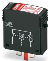
Fiche de protection antisurtension de type 2, avec varistance haute performance pour embase VAL-MS, surveillance thermique, signalisation optique de défaut. Version : 400 V AC
