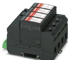
Parafoudres à 3 canaux, pour le montage sur NS 35/7,5, avec contact de télésignalisation (FM) comme contact inverseur, tension : 400 V AC
