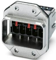
Cadre Push-Pull en métal, variante 14, incl. élément de contact avec raccordement à ressort, détrompage flexible, pour découpe de montage rectangulaire, avec joint, sans vis de fixation
