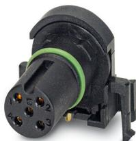
Connecteurs encastrables pour capteurs/actionneurs, connecteur femelle, 5 pôles, détrompage A, raccordement soudé coudé, uniquement élément de contact
