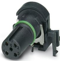
Porta-contatos, 4-pôles, connecteur femelle, coudé, M12-SPEEDCONNEC, détrompage: A, Montage circuits imprimés, Soudage à la vague, Produit de remplacement selon RoHS II sans exception 6c (Pb < 0,1 %) référence : 1239612
