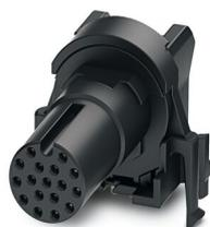
Porta-contatos, 17-pôles, connecteur femelle, coudé, M12, détrompage: A, Montage circuits imprimés, Soudage à la vague, Produit de remplacement selon RoHS II sans exception 6c (Pb < 0,1 %) référence : 1239454
