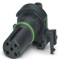
Porta-contatos, 4-pôles, connecteur femelle, coudé, M12-SPEEDCONNEC, détrompage: A, Montage circuits imprimés, Soudage à la vague, Produit de remplacement selon RoHS II sans exception 6c (Pb < 0,1 %) référence : 1239625
