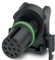
Porta-contatos, 12-pôles, connecteur femelle, coudé, M12, détrompage: A, Montage circuits imprimés, Soudage à la vague, Produit de remplacement selon RoHS II sans exception 6c (Pb < 0,1 %) référence : 1239452
