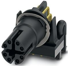
Porta-contatos, Ethernet CAT6<sub>A</sub> (10 Gbit/s), 8-pôles, connecteur femelle, coudé, M12, détrompage: X, Montage circuits imprimés, Soudage à la vague, Produit de remplacement selon RoHS II sans exception 6c (Pb < 0,1 %) référence : 1237389
