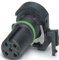
Porta-contatos, 5-pôles, connecteur femelle, coudé, M12-SPEEDCONNEC, détrompage: A, Montage circuits imprimés, Soudage à la vague, Produit de remplacement selon RoHS II sans exception 6c (Pb < 0,1 %) référence : 1239611
