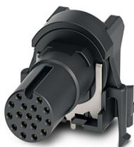
Porta-contatos, 17-pôles, connecteur femelle, coudé, M12, détrompage: A, Montage circuits imprimés, Soudage à la vague, Produit de remplacement selon RoHS II sans exception 6c (Pb < 0,1 %) référence : 1239458
