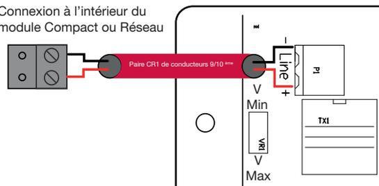
Line + - connecteur sur le module Compact ou Réseau vers le 'Line +' de l'interphone type B
