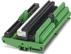
Module à relais de sortie 24 V DC à 32 canaux avec raccordement vissé et connexion système redondante à 50 pôles, fusible et cavalier dans chaque circuit de sortie, pour Yokogawa ADV551 et ADV561, à commutation par impulsions
