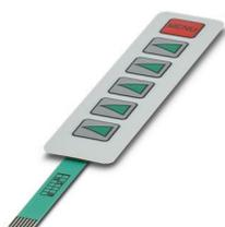
Clavier à membrane autocollant, technologie des pistes conductrices en argent, 6 touches, estampé, 4 couleurs, câble de raccordement : 50 mm, pas : 1 mm, température de service : - 20 °C ... 70 °C
