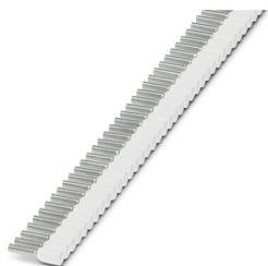
Embouts en bandes, 0,5 mm<sup>2</sup>, longueur de douille 8 mm, avec col en plastique, conformément à la norme DIN 46228-4, coloris blanc, pour traitement avec le CRIMPFOX 4 IN 1, 10 bandes avec 50 douilles par bande.
