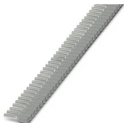
Embout, Dimensions suivant DIN 46228-4, avec col en plastique, dans un code couleur conforme à la norme NF C 63-023:1994-02, pour traitement avec le CRIMPFOX 4 in 1, longueur de la douille: 8 mm, coloris: gris, nombre de rubans: 10, nombre de douilles par bande: 40
