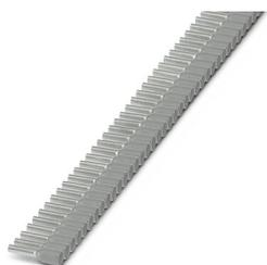
Embouts en bandes, 0,75 mm<sup>2</sup>, longueur de douille 8 mm, avec col en plastique, conformément à la norme DIN 46228-4, coloris gris, pour traitement avec le CRIMPFOX 4 IN 1, 10 bandes avec 50 douilles par bande.
