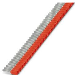
Embouts en bandes, 1,0 mm<sup>2</sup>, longueur de douille 8 mm, avec col en plastique, conformément à la norme DIN 46228-4, coloris rouge, pour traitement avec le CRIMPFOX 4 IN 1, 10 bandes avec 50 douilles par bande.
