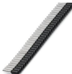
Embouts en bandes, 1,5 mm<sup>2</sup>, longueur de douille 8 mm, avec col en plastique, conformément à la norme DIN 46228-4, coloris noir, pour traitement avec le CRIMPFOX 4 IN 1, 10 bandes avec 50 douilles par bande.
