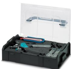
Outil pour le traitement des embouts de  $0,5 \text{ mm}^2$  à  $2,5 \text{ mm}^2$ , conformément à la norme DIN 46228-4, équipé d'un dispositif de blocage, d'une unité de coupe, de dénudage, de torsion et de sertissage, avec trois chargeurs, y compris une bande d'embout de  $0,5 \text{ mm}^2$  ...  $2,5 \text{ mm}^2$ , emballé dans un coffret robuste en plastique
