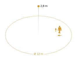
Hauteur d'instal lation: 2,50 m – 4,00 m Orange: sens de passage radial et tangentiel
