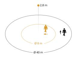
Hauteur d'instal lation: 2,50 m - 4,00 m Orange: sens de passage radial Noir: sens de passage tangentiel
