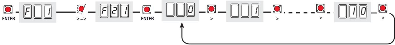
**F 22 (Durée de fonctionnement) :** temps de fonctionnement des moteurs dans la phase d'ouverture ou de fermeture.
