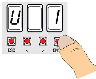
2) Choisissez la commande (1= pas-à-pas, 2= séquentielle, 3=ouverture, 4=ouverture pour piétons/partielle, 5=sortie contact B1-B2) à associer à l'utilisateur en utilisant les flèches.
