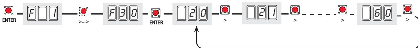
**F 31 (Vitesse de ralentissement du moteur M2) :** configuration de la vitesse pendant les ralentissements du moteur M2, calculée en pourcentage.
