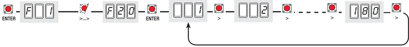
**F 21 (Temps de préclignotement) :** après une commande d'ouverture ou de fermeture, le clignotant raccordé sur (10-E), clignote pendant un temps réglable avant de commencer la manœuvre.
