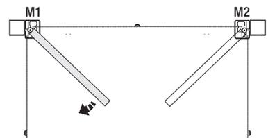
**N.B. :** avant d'effectuer le calibrage de la course, contrôlez s'il n'y a pas d'obstacle dans la zone de manœuvre et assurez-vous de la présence d'une butée d'arrêt mécanique en ouverture et une en fermeture.
