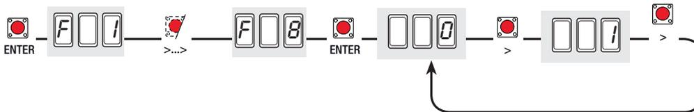
**F 9 (Détection d'obstacles) :** avec le moteur à l'arrêt (portail fermé, ouvert ou après une commande de stop total), elle empêche n'importe quel mouvement si les dispositifs (ex : photocellules) détectent un obstacle.
