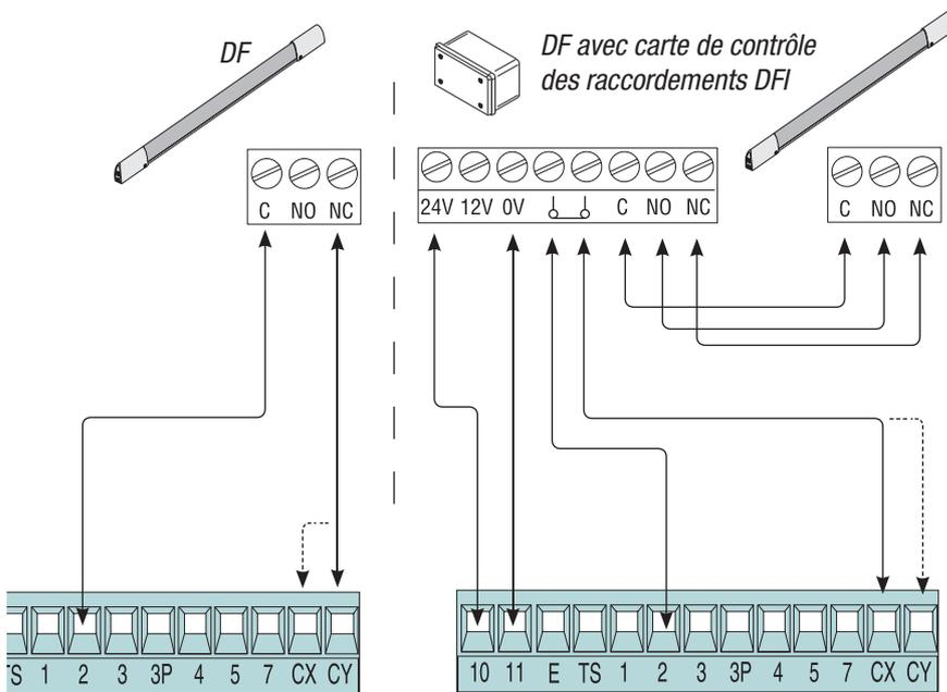
Raccordement électrique pour le fonctionnement du test de sécurité des photocellules
