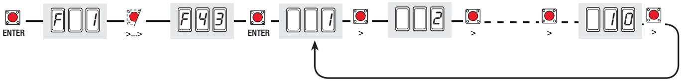
**F 44 (Point de déplacement fermeture du moteur M2) :** elle règle le point de début du déplacement du moteur (M2) avant le fin de course de fermeture. Le point de début du déplacement est calculé en pourcentage sur la course complète du vantail. (voir par illustration des zones et des points de ralentissement et de déplacement)
