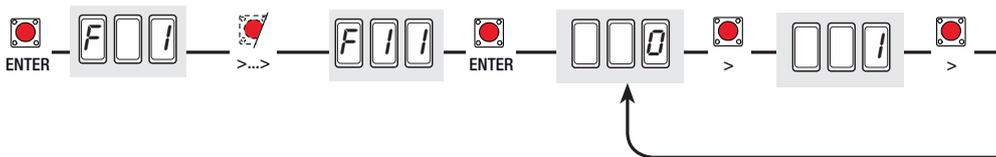
**F 12 (Départ ralenti) :** à chaque commande d'ouverture ou de fermeture, les vantaux partent lentement pendant quelques secondes.
